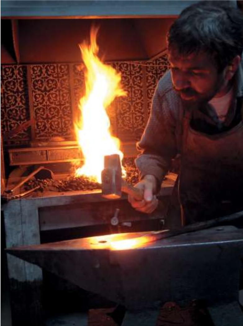
**Forges anciennes avec le marteau et l'enclume au premier plan et l'âtre au fond. L'enclume est un bloc d'acier généralement fixé sur un billot en bois dont la hauteur est calculée en fonction de la taille du forgeron.**
