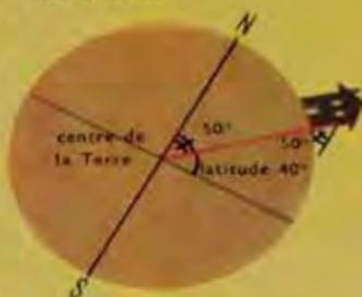
Position que doit prendre l'aiguille du cadran à une latitude déterminée.
